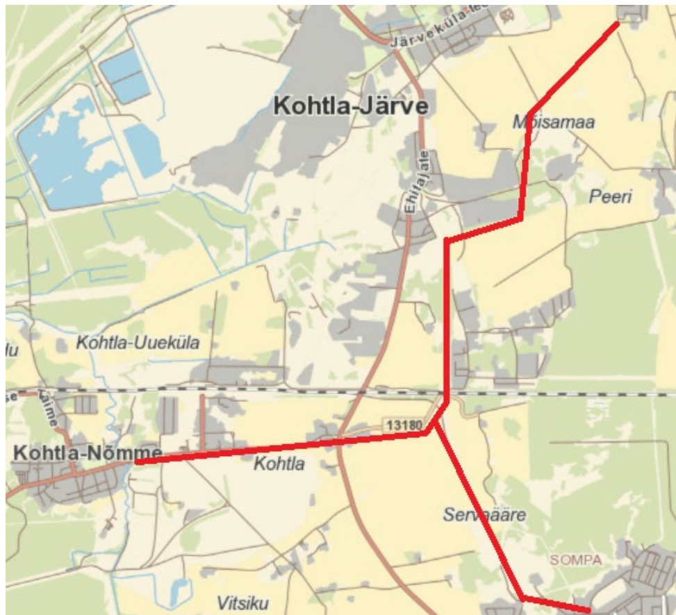
Joonis 20. Kohtla-Nõmme ja Sompa ühendamine Kohtla-Järve veevõrguga võimaldaks tagada piirkondadele stabiilsema ja nõuetele vastava joogiveevarustuse, suurendada süsteemi varustuskindlust, vähendada sõltuvust kohalikest puurkaevudest ja eraldiseisvatest veetöötlusseadmetest ning koondada veevarustussüsteemi käitamise ja hooldamise.
