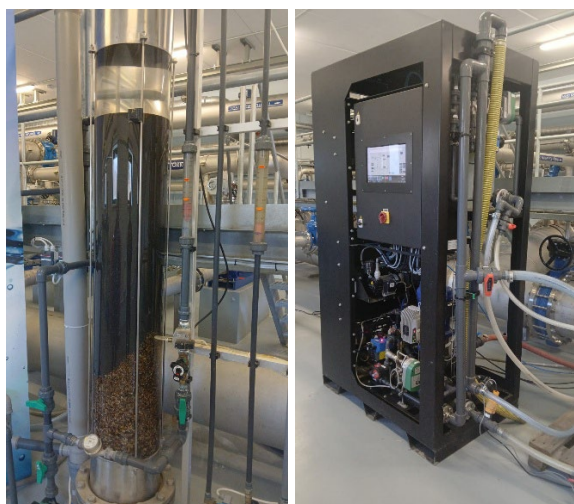
Joonis 35. Vasakul: Ahtme veetöötlusjaamas olev filtrimise katseseade täideti \text{MnO}_x kattega filtermaterjaliga (musta värvi). Paremal: Nanofiltratsiooniseade.
